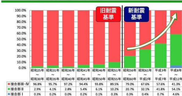
柱の接合部仕様 割合の変化
